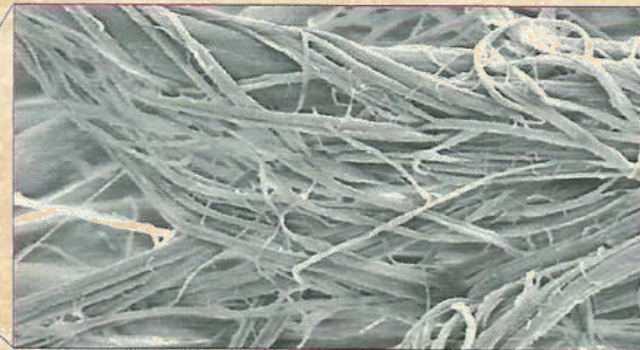
A végeredmény: szétbontott, kb. 500 nm vastagságú elemiszálak
