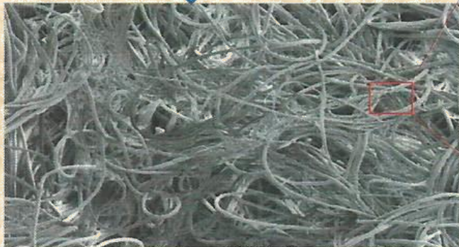
Vízugárral kuszált és szétbomlott szálak
