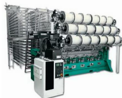
22. ábra. Korszerű csipkefüggönygyártó raschel-gép (K. Mayer)
