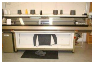
31. ábra. Síkkötőgép, amely egy darabban köt meg egy teljes pulóvert ( Shima Seiki )
