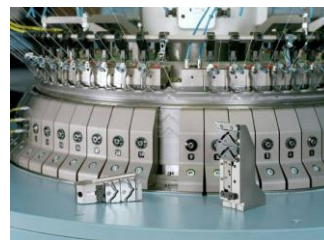
35. ábra. A körkötőgépek legfőbb jellemzője a kerület mentén elhelyezett számos munkaegység (Mayer & Cie.)
