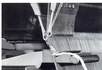
15. ábra. Horgas tűvel működő lánchurkológép szemképző eszközei [28]
