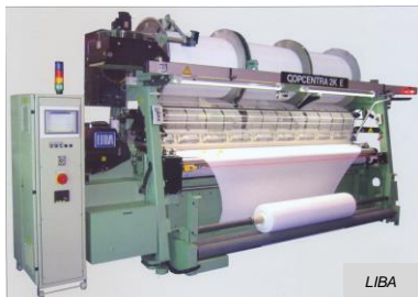
16. ábra. Lánchurkológép 2011-ben. (A gép maximális teljesítménye 3700 szemsor/perc!)
