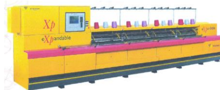
11. ábra. 4 fonturos síkhurkológép 2007-ből (Tecnotessile)
