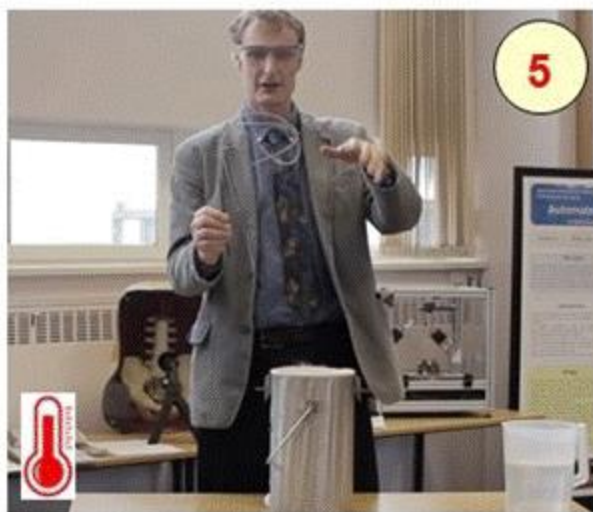
a deformálódott pálcá kezdődő visszaalakulása
