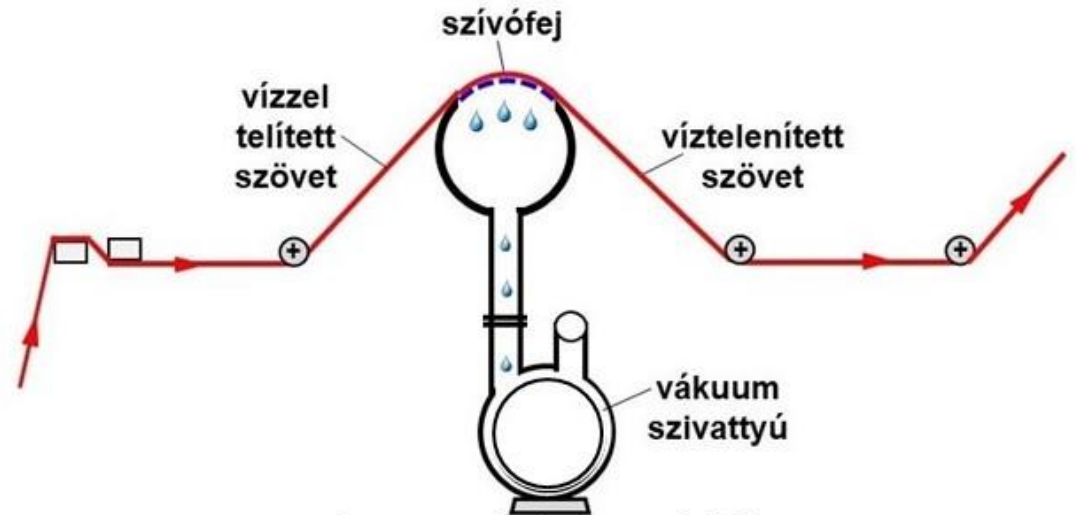
a vákuumszívógép felépítése
