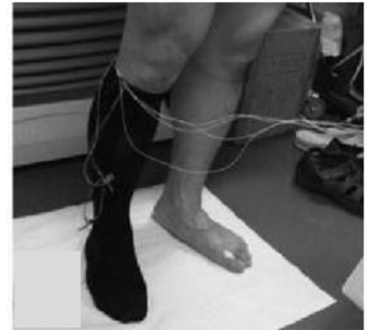
a kompressziós harisnya által kifejtett nyomás mérése
