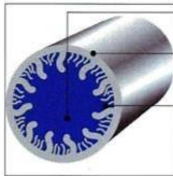
poliamid mikroszál ezüst bevonat érdesített szárfelület
