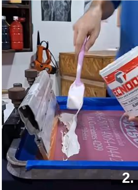
2. a síksablon ráhelyezése, a pép betöltése
